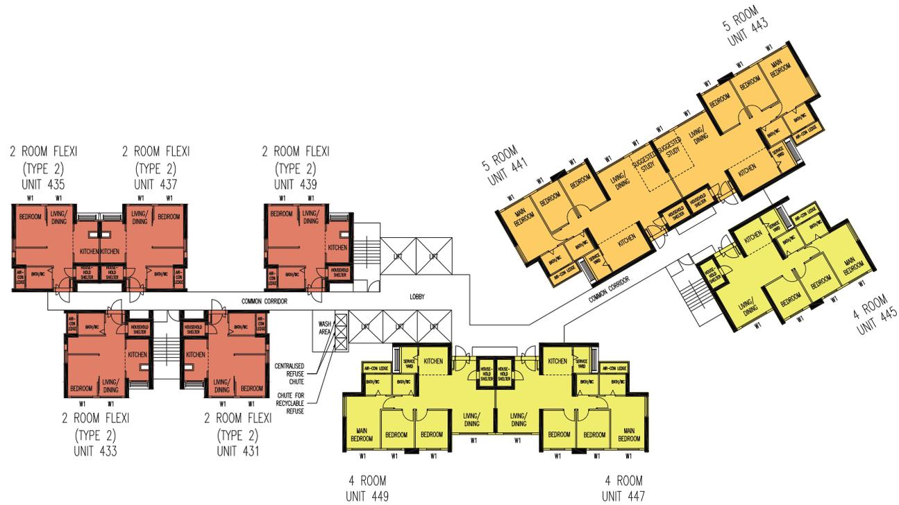
**BLOCK 224A** | 3RD TO 34TH STOREY FLOOR PLAN
