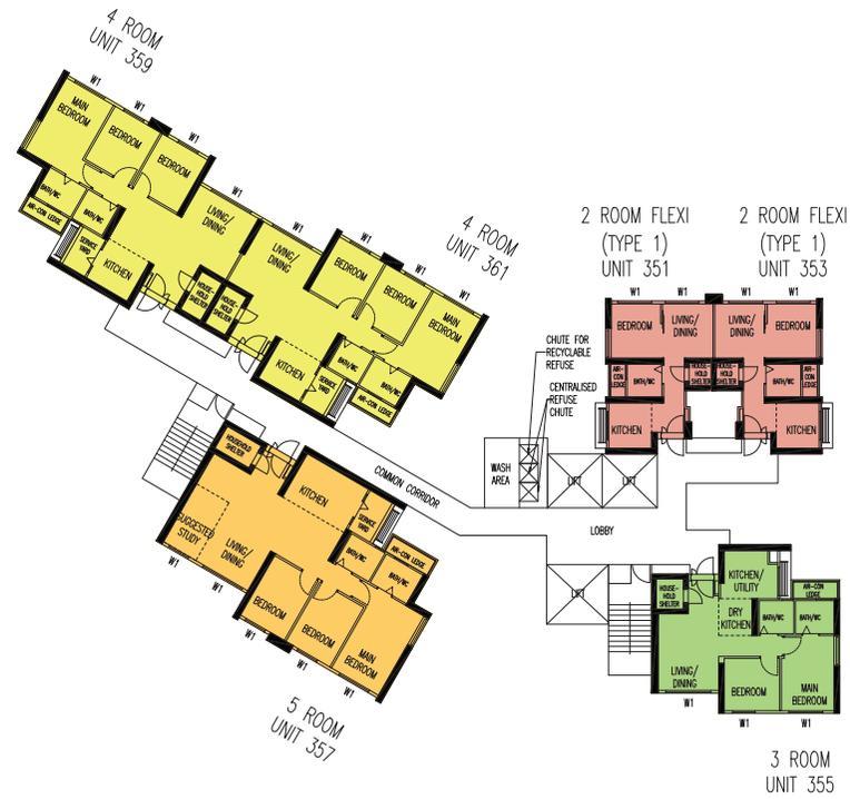
**BLOCK 219A | 3RD TO 34TH STOREY FLOOR PLAN**
